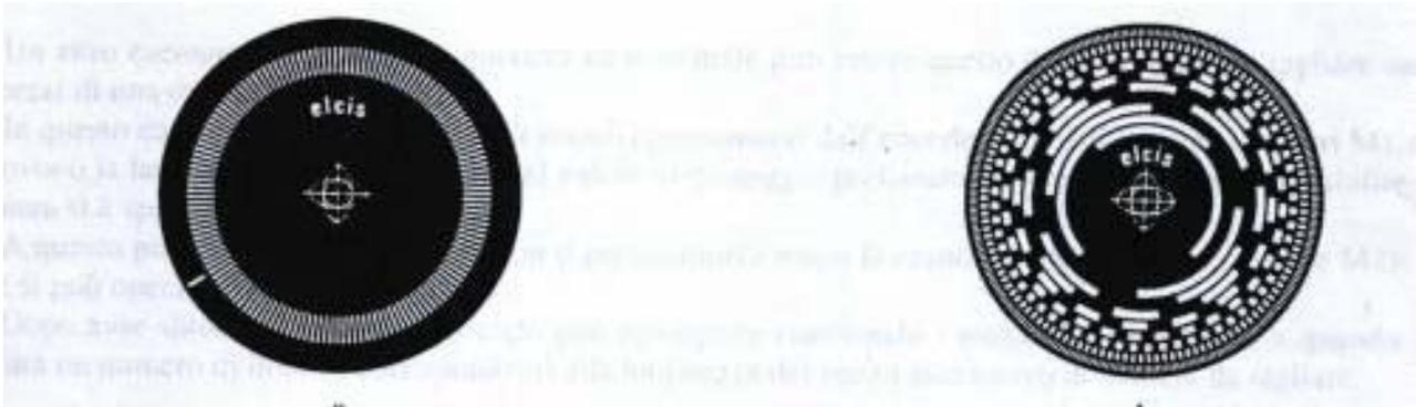
**A sinistra:** Disco di un encoder incrementale. Da notare le tacche che caratterizzano l'uscita e la singola tacca il cui scopo è quello di indicare la posizione di zero dell'albero.
